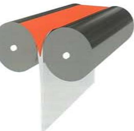
Рис. 7. Двухвалковый кристаллизатор
