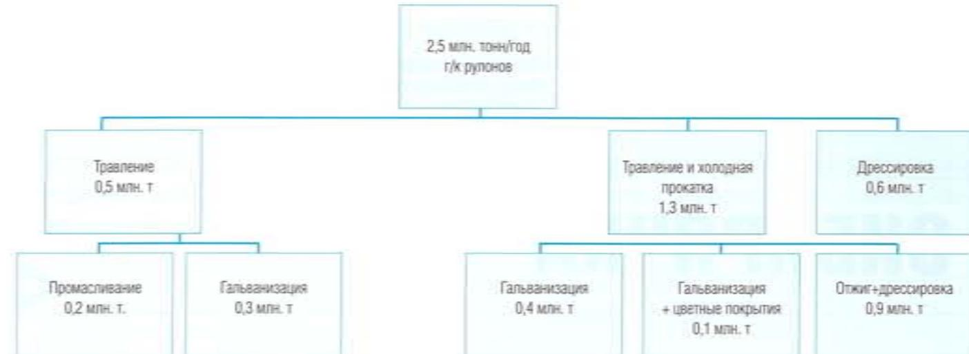
Рис. 11. Переработка горячекатанных рулона в ЦХП
