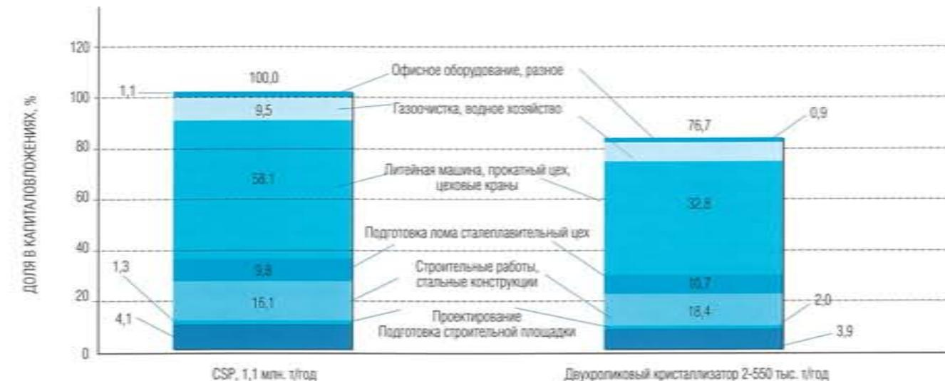
Рис. 9. Распределение стоимости капиталовложений в агрегаты CSP и Twin Roller со сдачей «под ключ»
