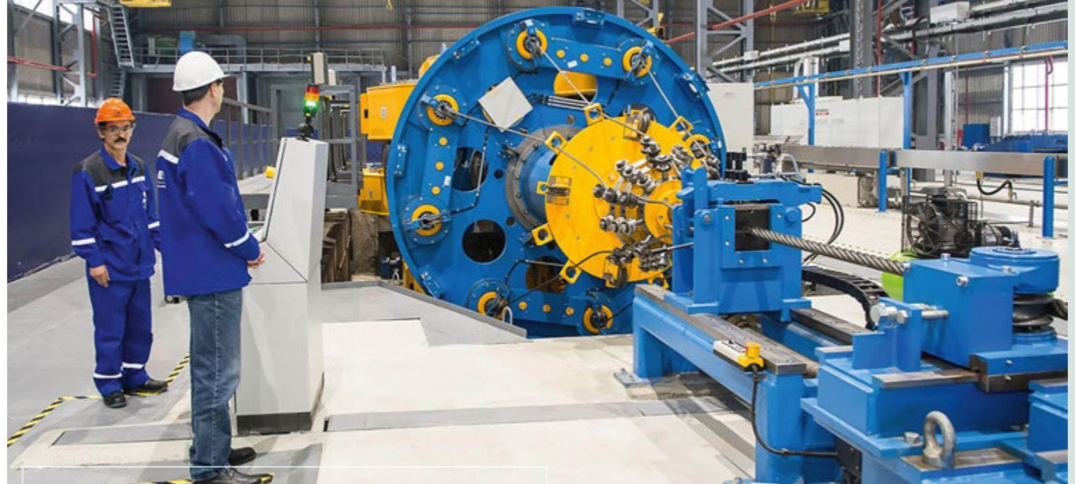
КАНАТЫ, ПРОИЗВЕДЕННЫЕ НА КАНАТНОЙ МАШИНЕ КОРЗИНОЧНОГО ТИПА, ИСПОЛЬЗУЮТСЯ В УГОЛЬНОЙ И ГОРНОРУДНОЙ ПРОМЫШЛЕННОСТИ, ГАЗОНЕФТЕДОБЫЧЕ, ГРУЗОПОДЪЕМНОЙ ТЕХНИКЕ, РЫБОЛОВСТВЕ
