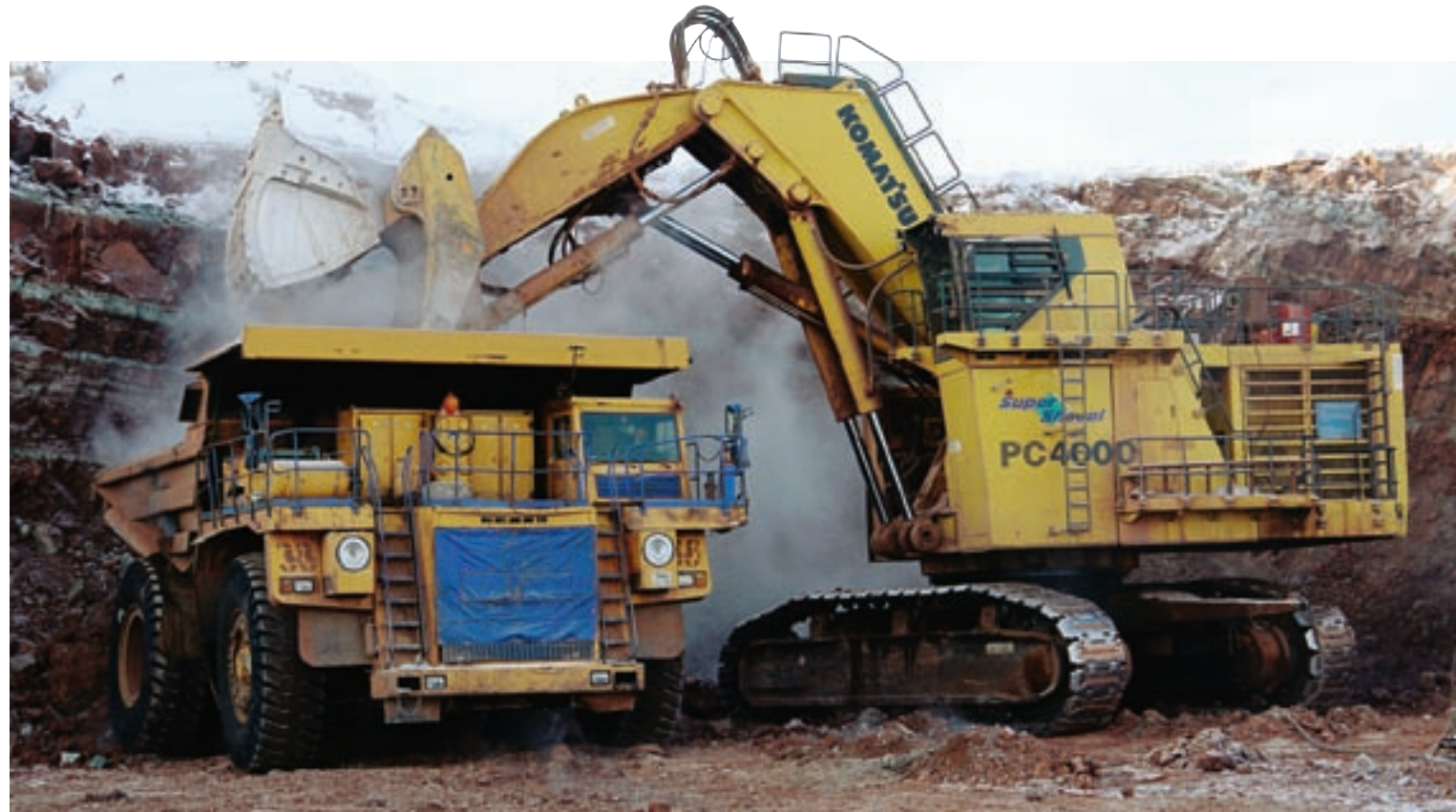
Экскаватор и самосвал – основа любого горнодобывающего про- изводства открытым способом. Грузоподъемность этого самосва- ла – 130 тонн. Объем ковша экскава- тора – 19 кубометров или более 50 тонн горной массы
