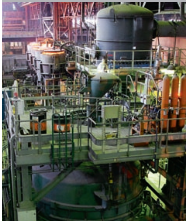
Процесс вакуумирования занимает 20–25 минут
