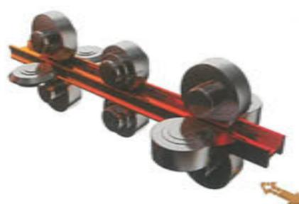
постоянное производство заготовок, в то время как производительность типового прокатного стана, предназначенного для производства балочных профилей, изменяется в зависимости от размеров прокатываемых профилей от 70 до 170 тонн в час при степени готовности к работе 80%. Для компенсации простоев стана на перевалку используется реверсивный холодильник. Оставшиеся на промежуточном складе (накопителе) заготовки
