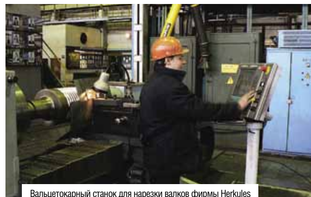
Вальцетокарный станок для нарезки валков фирмы Hercules
