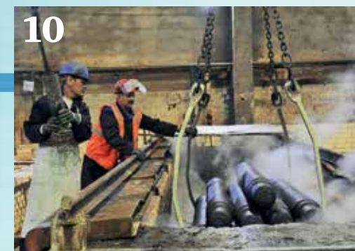
10 В травильном отделении оси «принимают ванны» со специальным раствором, содержащим серную кислоту. Таким образом убирается окалина, которая образовалась в процессе обработки.
