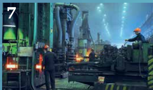
7 Окончательная правка – обрезка концевых цапф и придание оси идеально прямой формы – происходит на механическом прессе усилием 1600 тонна-сил. Кроме этого, в верхней части рабочего инструмента крепится клеймо, которое отражает шифр продукции, номер смены, которая ее изготовила, и даже номер плавки исходного металла. «Безымянных» осей на заводе не бывает.
