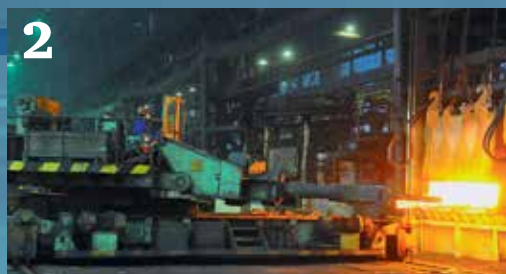
2 Порезанную заготовку нагревают в камерных печах в среднем до 1230 градусов. При более низкой температуре качественно деформировать металл не получится.
