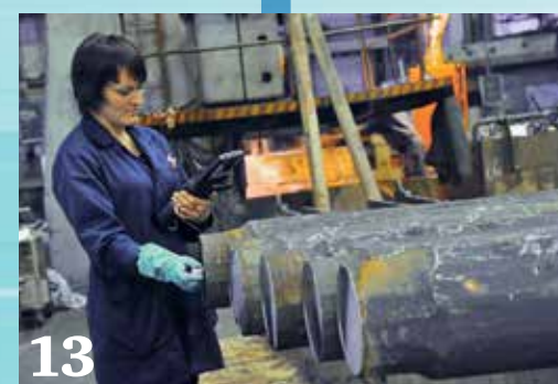
13 Ультразвуковому контролю подвергается каждая ось. Цель – убедиться в отсутствии внутренних дефектов. Дополнительно в аккредитованной испытательной лаборатории проводят выборочный контроль для подтверждения требуемого уровня механических свойств.
