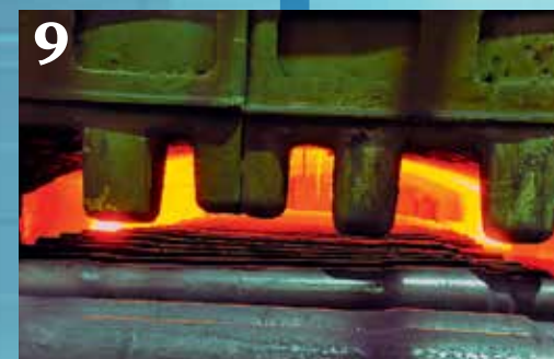
9 И снова – нагрев. На этот раз в проходных печах для термической обработки. Средняя температура здесь – 860 градусов, время пребывания – 5–6 часов. Металл меняет свою структуру, приобретая необходимые механические свойства.
