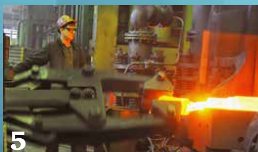
5 Далее – на штамповочный 16-тонный молот. За 25–30 ударов заранее заготовленным штампом получается практически готовая ось.
