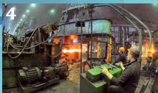
4 Вначале «разминка». На новочном молоте с усилием падающих частей в 8 тонн заготовка меняет форму своего сечения с квадратной на круглую, приближенную размерами к будущей оси. Теперь заготовка называется фасонной.
