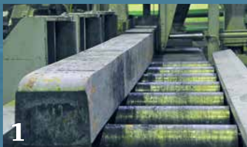
1 Будущие ж/д оси поступают в «Уральскую кузницу» в виде длинных заготовок квадратного сечения, которые режут на лентопильном станке на заготовки необходимой длины.
