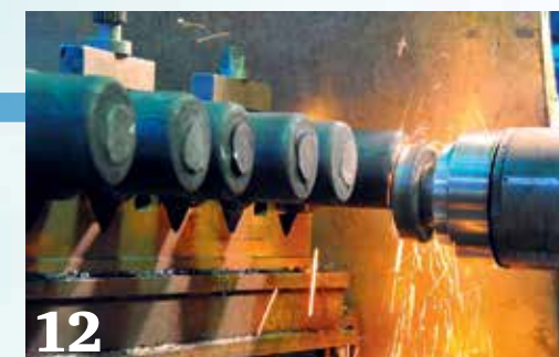
12 Механическая обработка проводится по требованию заказчика. «Уральская кузница» производит как черновые, так и обточенные оси. Торцы всех осей без исключения обрабатывают, чтобы провести ультразвуковой контроль.
