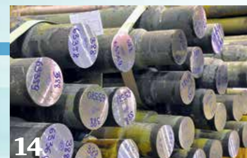
14 На каждую ось ставят клеймо отдела технического контроля «Уралкуз» и клеймо заказчика – РЖД. Независимый инспектор постоянно работает на территории завода.
