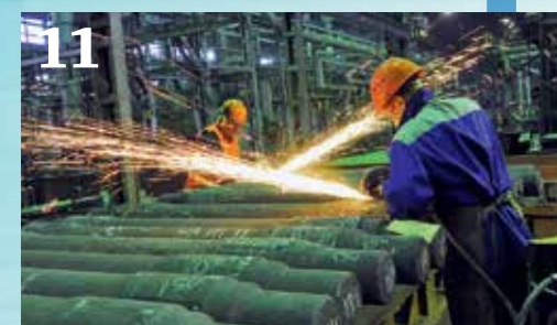
11 Разбраковка – проверка на наличие наружных дефектов. После исследования все «подозрительные» участки обрабатывают бормашиной, чтобы убедиться в отсутствии глубоких дефектов.
