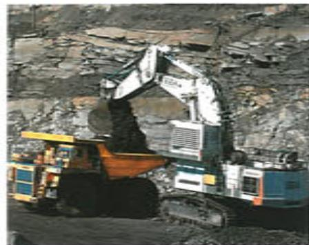
В июне-июле были запущены два экскаватора Liebherr на разрезах «Красногорский» и «Сибиргский» ОАО «Южный Кузбасс». Кроме того, экскаватор марки Liebherr с ковшом емкостью 9 куб. метров, введен в эксплуатацию на Коршуновском карьере ОАО «Коршуновский ГОК». Он предназначен для отработки железной руды с нижних горизонтов открытым способом. Ввод нового экскаватора позволит вывести из эксплуатации два устаревших экскаватора и повысить годовую производительность работ по выемке руды на 30%.
