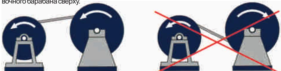
В случае размотки каната с бухты заранее отрезанного мерного куска, ее необходимо установить на поворотный разматыватель и тянуть за наружный конец каната, вращая бухту.
