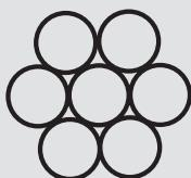
Канаты стальные по ТУ 14-4-1306-85 изготавливаются из проволоки высоколегированной коррозионностойкой стали марок 12Х18Н9Т или 12Х18Н9 и 12Х18Н10Т.
