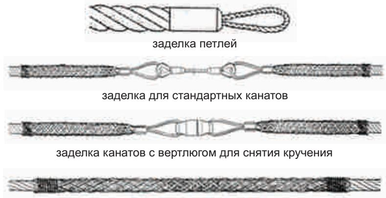
Использование канатов, изготовленных с петлей на конце позволяет значительно снизить трудоемкость замены канатов, а так же вероятность повреждения каната в процессе его навески.
