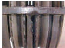
**Заедание** канатов на блоках может происходить в том случае, если заклиниваются подшипники блока либо канат задевает за ограждающее устройство блока. Ввиду того, что эти неисправности приводят к интенсивному износу ручья блоков и каната, их необходимо немедленно устранять. Если погнуто ограждение, его следует выправить или разогнуть, обеспечив свободный проход каната. Подшипники блоков необходимо прочистить и заполнить чистой смазкой или заменить новыми.
