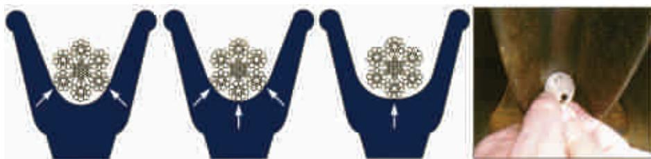
Диаметр каната замеряют штангенциркулем по ГОСТ 166 с ценой деления не более 0.1 мм или микрометром по ГОСТ 6507 с ценой деления не более 0.01 мм на расстоянии не менее 5 м от конца каната в ненагруженном состоянии.
