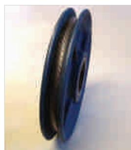
**Закручивание** каната обычно происходит из-за того, что канат неправильно разматывали из бухты во время его запасовки на блоках. Предотвратить неисправ-
