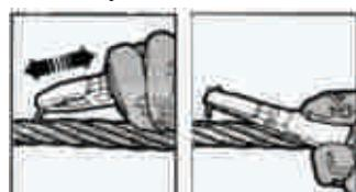
Канат в процессе эксплуатации должен регулярно с равномерными интервалами смазываться смазкой. Эксплуатационная смазка должна быть совместима с видом канатной смазки, наносимой в процессе изготовления, которая указана в сертификате на канат.
