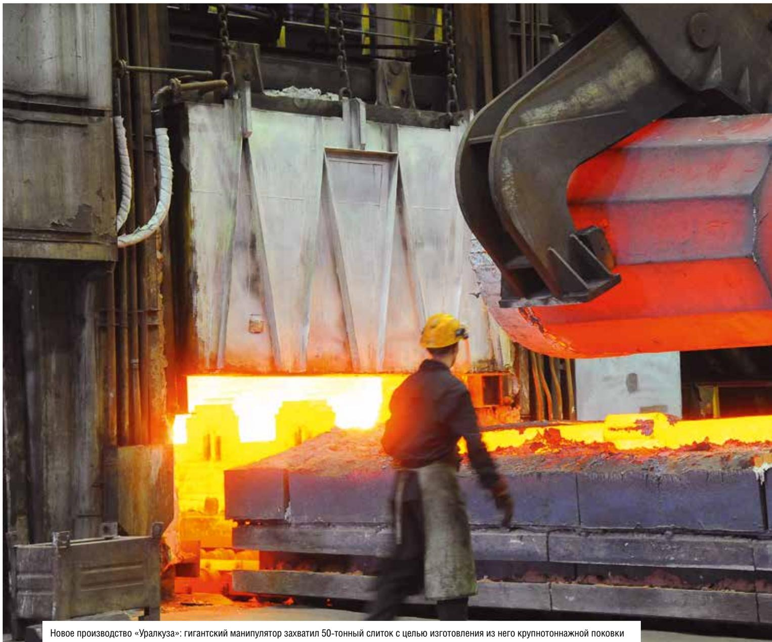
Новое производство «Уралкуза»: гигантский манипулятор захватил 50-тонный слиток с целью изготовления из него крупнотоннажной поковки
