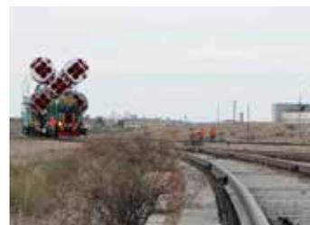
космической инфраструктуры. Рельсы Р65 предназначены для ремонта и укладки железнодорожных путей, по которым ракеты доставляют на стартовый комплекс. На космодромы направлено около тысячи тонн рельсов. Поставки планируется продолжить.
