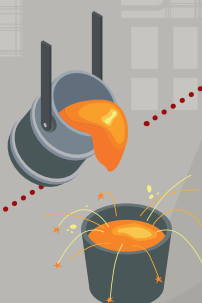
Далее на ЧМК в кислородно- конвертерном цехе выплавляли сталь. Для регулирования химического состава и достижения необходимых качественных характеристик в нее в том числе добавили флюс из обожженной извести и ферросилиций
