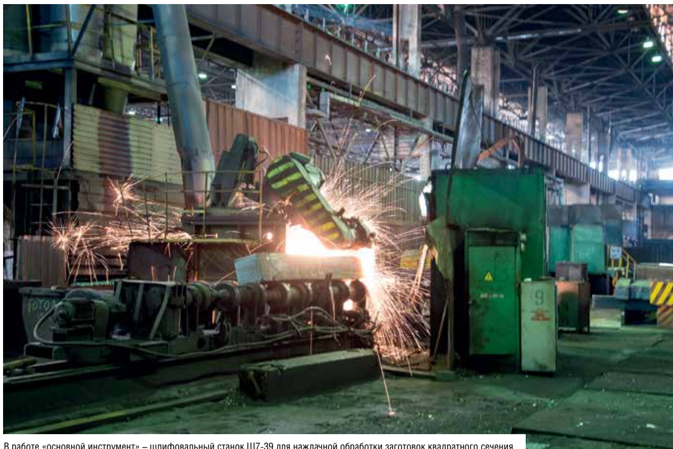
В работе «основной инструмент» – шлифовальный станок Ш7-39 для наждачной обработки заготовок квадратного сечения
